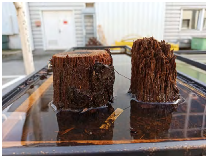
Aquarium comportant des vestiges en bois archéologiques du lac de Banyoles pour simuler un vieillissement accéléré des bois dans différentes situations climatiques, biologiques et géologiques.
