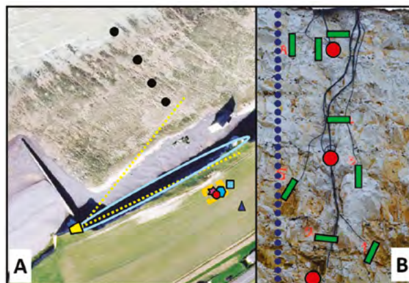
Suivi multi-capteurs de la falaise de craie de Sainte-Marguerite-sur-Mer (76) : A) vue aérienne avec l'emprise du suivi et capteurs. B) vue de la paroi de la falaise avec implantation des géophones « horizontaux », extensomètres et capteurs de température (nov. 2018).
