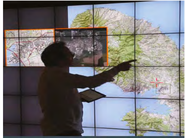
Une « DragMag » sur un mur d'écran tactile montre une représentation à plus grande échelle d'une partie de la carte tout en montrant simultanément une carte topographique et une image aérienne.
