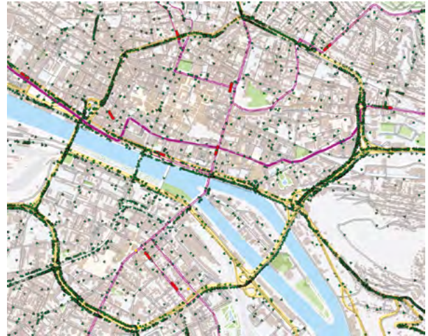
Simulation numérique du déplacement de voitures (verts) et d'autobus (rouges) sur le réseau routier de l'agglomération rouennaise. La calibration du modèle à partir d'enquêtes ménages déplacements et la comparaison des résultats de simulations avec des données de trafic observés permet de valider le modèle. Crédit : Clément Caron, Éric Daudé / IDEES UMR 6266.
