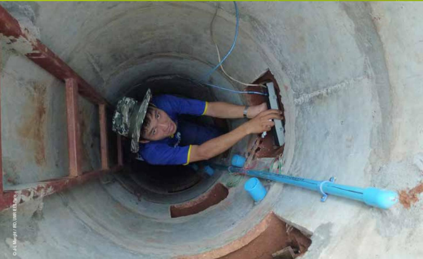
► Installation de rhizotrons à l'intérieur d'un puits d'observation. La croissance des racines a été mesurée jusqu'à 5 m sous plantation de teck (*Tectona grandis*) dans le Nord du Laos.
