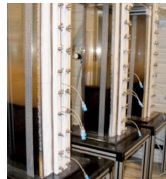
Colonnes de sédiments permettant de suivre la géochimie de l'eau interstitielle du sédiment et de l'eau sus-jacente, ainsi que la répartition de l'arsenic dans ces différentes zones
