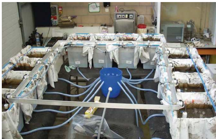
Figure 1 : Dispositif expérimental. Les sédiments de l'aber Benoit ont été maintenus en microcosmes au "CEDRE" (Brest, France). 12 microcosmes (30 L de sédiment chacun) ont été soumis à quatre conditions: trois contrôles (sédiments seuls), trois pollués avec du pétrole BAL 110, trois bioturbation dans lesquels Nereis diversicolor a été ajouté, et trois pollués avec bioturbation. Un collecteur récoltant les eaux de la marée a été placé au centre. A chaque cycle de marée l'eau de mer est renouvelée.
