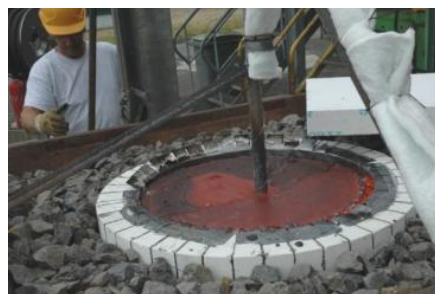
Fig.2 : réalisation d'une mise en forme en sortie de coulée sur le site de vitrification.
