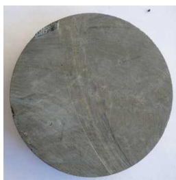
Fig.1 : céramiques issues de la vitrification de déchets amiantés
