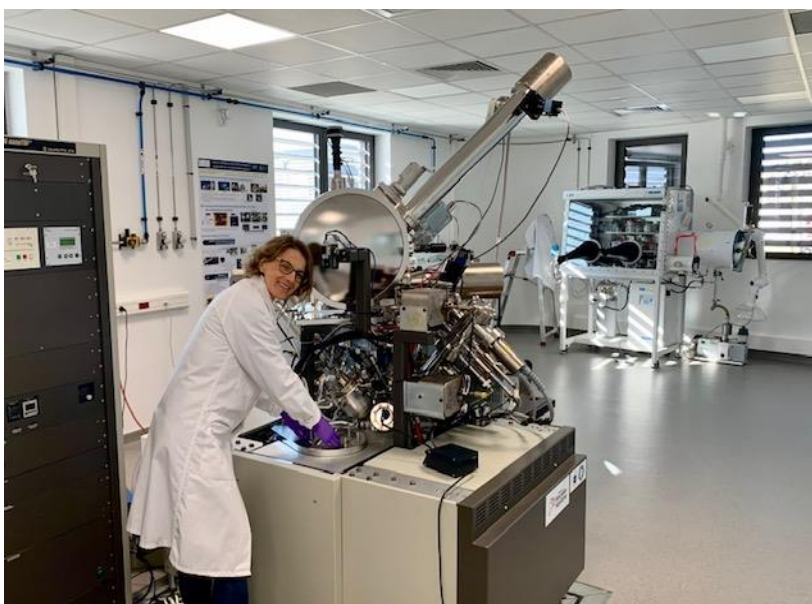
Installation du spectromètre ToFSIMS permettant d'étudier la réactivité aux interfaces des solides à l'échelle nanométrique (© MARSS)
