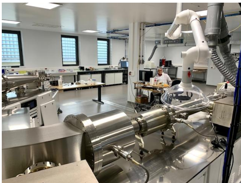
Installation du spectromètre Nu 1700 facilitant l'analyse des formes chimiques des métaux en solution (© MARSS)
