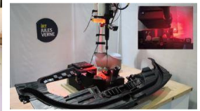
Base mobile autonome avec navigation sécurisée (à gauche) ; système de vissage autonome (basé sur asservissement visuel) appliqué à l'assemblage de systèmes d'opération de planches de bord (cas d'application FAURECIA) - Projet MASCOT
