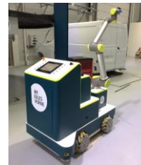
Base mobile autonome avec navigation sécurisée (à gauche) ; système de vissage autonome (basé sur asservissement visuel) appliqué à l'assemblage de systèmes d'opération de planches de bord (cas d'application FAURECIA) - Projet MASCOT
