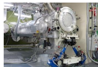
Système d'insertion de diagnostics installé dans le LMJ conçu dans le cadre de l'Equipex PETAL+ © CEA
