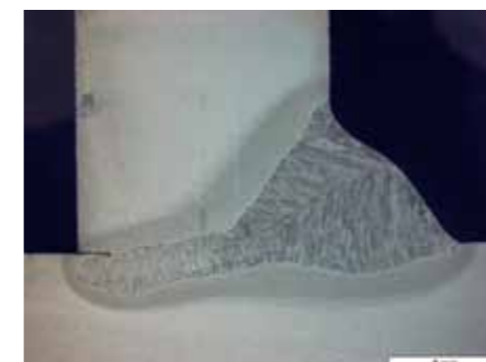
Soudage hybride en angle d'un acier S355 épaisseur 12 mm
