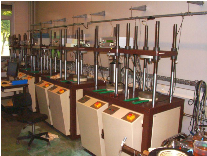
Banc d'essai pour l'étude du fluage du sel sous sollicitations cycliques (LMS.SACRE)
