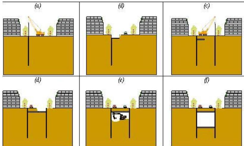
Figure 1 Principe général de la tranchée couverte : (a-b) construction d'un premier mur et d'une moitié de dalle de couverture ; (c-d) construction du second mur et achèvement de la couverture ; (e) terrassements 'en taupe' ; (f) fermeture du cadre.
