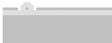
Dépôt SiO 2 protection NEMS
