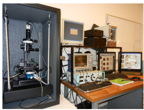
Vue de la plateforme expérimentale mise en place au début du projet, comprenant un AFM Agilent PicoPlus couplé à un module PFM analogique Wytec et à un prototype évolutif de Résiscope.
