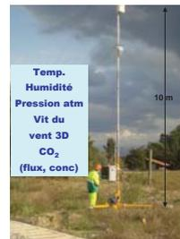
Station de mesure de la dynamique de transfert du CO<sub>2</sub> au niveau du couvert végétal (Rousse)
