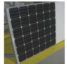
Module avec des cellules BSF bore à η=18,35%, en test de vieillissement chez Tenesol
