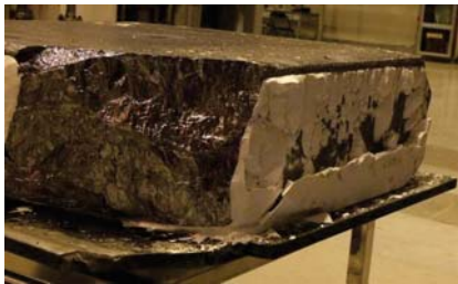
Fig1: Casse au démoulage d'un lingot de silicium suite à un coating de mauvaise qualité
