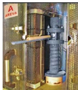
Electrolyseur simple cellule φ 40mm 600°C 100bars-Programme ANR Celeva
