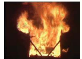
Essais feu pour qualification réservoir & protection thermique
