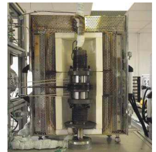
Electrolyseur double cellules φ 40mm 600°C 100bars-Programme ANR Heleva
