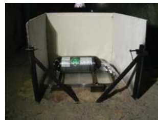
Essais feu pour qualification réservoir & protection thermique
