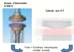
Bonne prédiction du niveau de fuite en fonction de la géométrie ou du serrage
