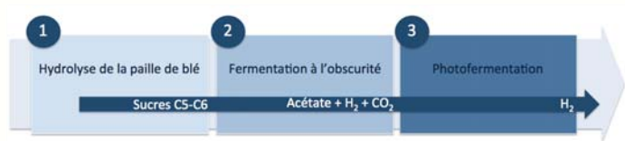
Figure 1: Couplage des procédés d'hydrolyse enzymatique, fermentation et photofermentation
