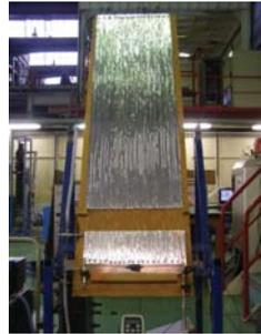
Figure 2-3 : expérimentation cavité (PIV) et caloducs
