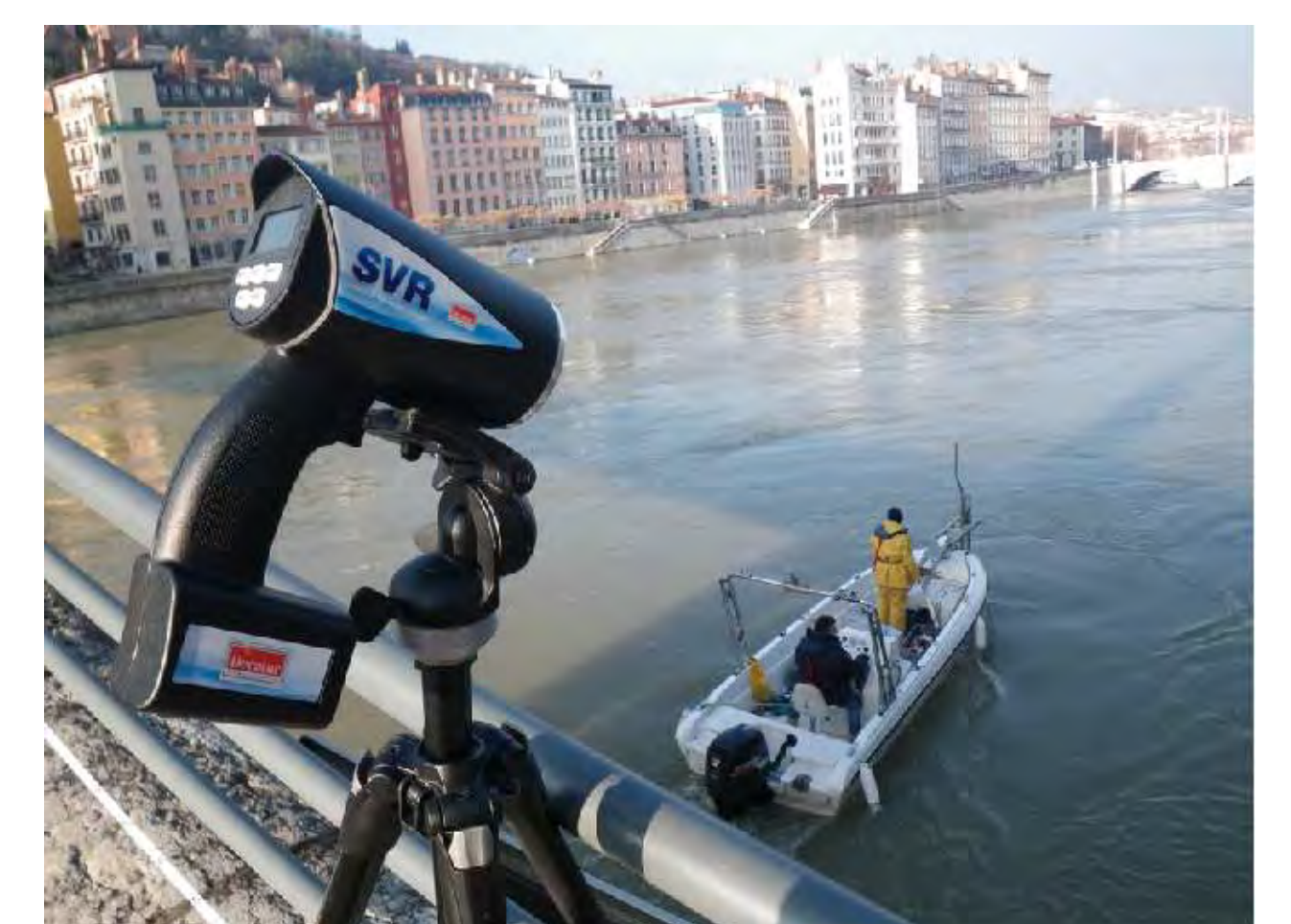
Figure 7: Radar de vitesse qui sera utilisé pour les jaugeages sur alerte
