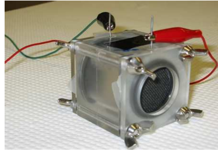
PACM 28 mL avec cathode à air B.E. Logan Penn State university
