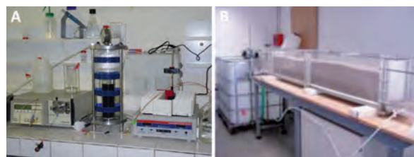
Dispositifs expérimentaux pour l'étude du transfert de suspensions de nanoparticules A) à travers une colonne de roche en appliquant une contre pression, et B) sous gradient hydraulique dans un pilote rempli de sable
