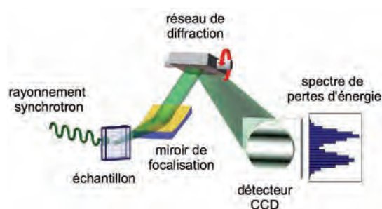
Schéma de principe du spectromètre AERHA pour la diffusion RAMAN X résonante, alliant haute acceptation et haute résolution, développé pour la ligne de lumière Sextants du synchrotron SOLEIL.
