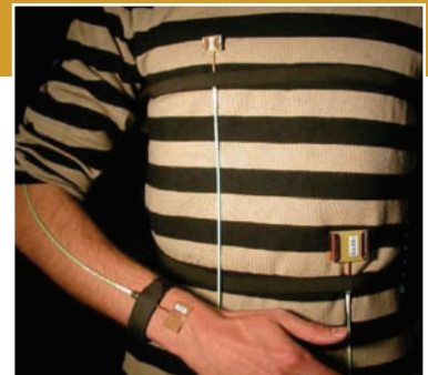
Système de caractérisation du canal de propagation radio entre plusieurs points sur le corps (3 antennes visibles).
