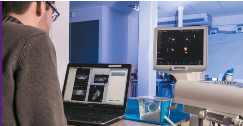
Robot guidé par l'imagerie ultrasonore 3D pour la curiethérapie du cancer de la prostate. Mise au point d'une version clinique
