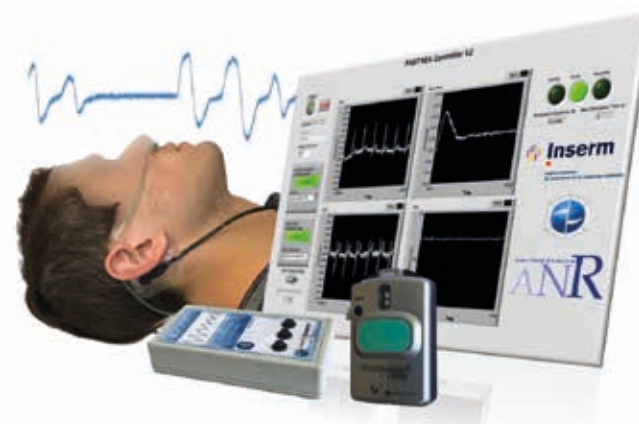
Le système PASITHEA est constitué d'un dispositif d'enregistrement ambulatoire, d'un dispositif de stimulation kinesthésique et d'une application de traitement du signal et de contrôle temps-réel (1) .
