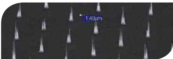
Croissance des nanotubes de carbones sur chaque photodiode.
